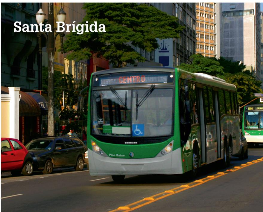
A Santa Brígida, operadora de transporte coletivo urbano da Zona Oeste da cidade de São Paulo, acaba de adquirir 20 chassis de ônibus piso baixo Scania. O modelo K 270 de 15 metros, dotado de motor de 270 hp de potência, de 9 litros e cinco cilindros, vem equipado com câmbio automático, terceiro eixo direcional e suspensão a ar. Nessa configuração permite transportar 25% a mais de passageiros comparado aos modelos convencionais de 12 ou 13 metros.
