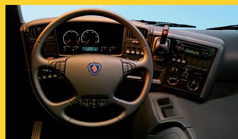
**A ergonomia cognitiva** trata da interação homem e máquina. Botões, controles, agrupamento de instrumentos, telas, sinais visuais e de áudio e também da sensação tátil dos botões e controles.
