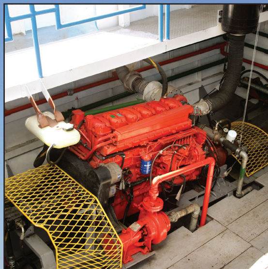
Praticidade de operação e manutenção: características que levaram dois motores Scania D112 41M a equipar o empurrador Cosan I
