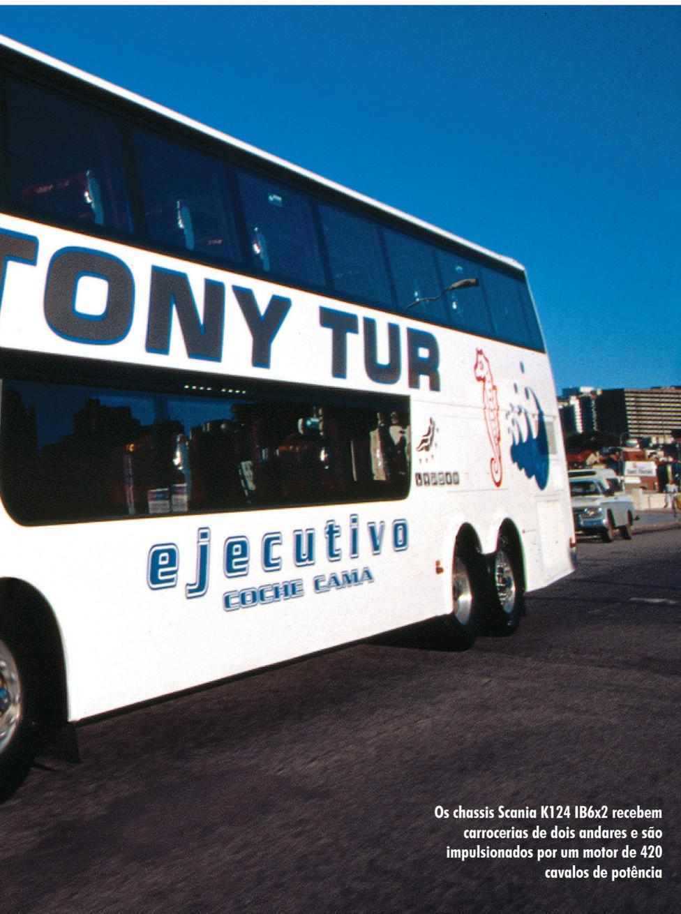
Os chassis Scania K124 1B6x2 recebem carrocerias de dois andares e são impulsionados por um motor de 420 cavalos de potência
