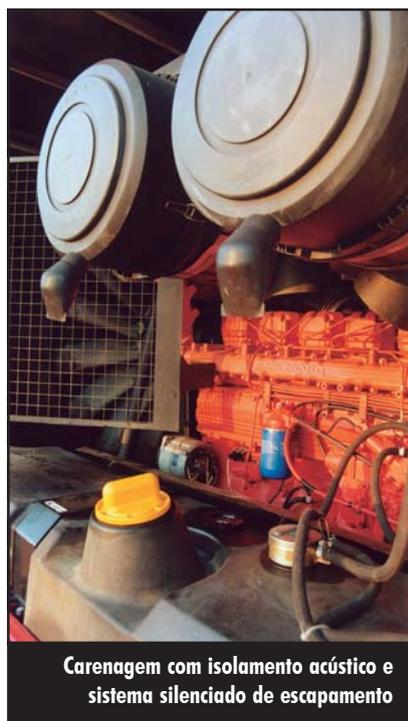
Carenagem com isolamento acústico e sistema silenciado de escapamento
