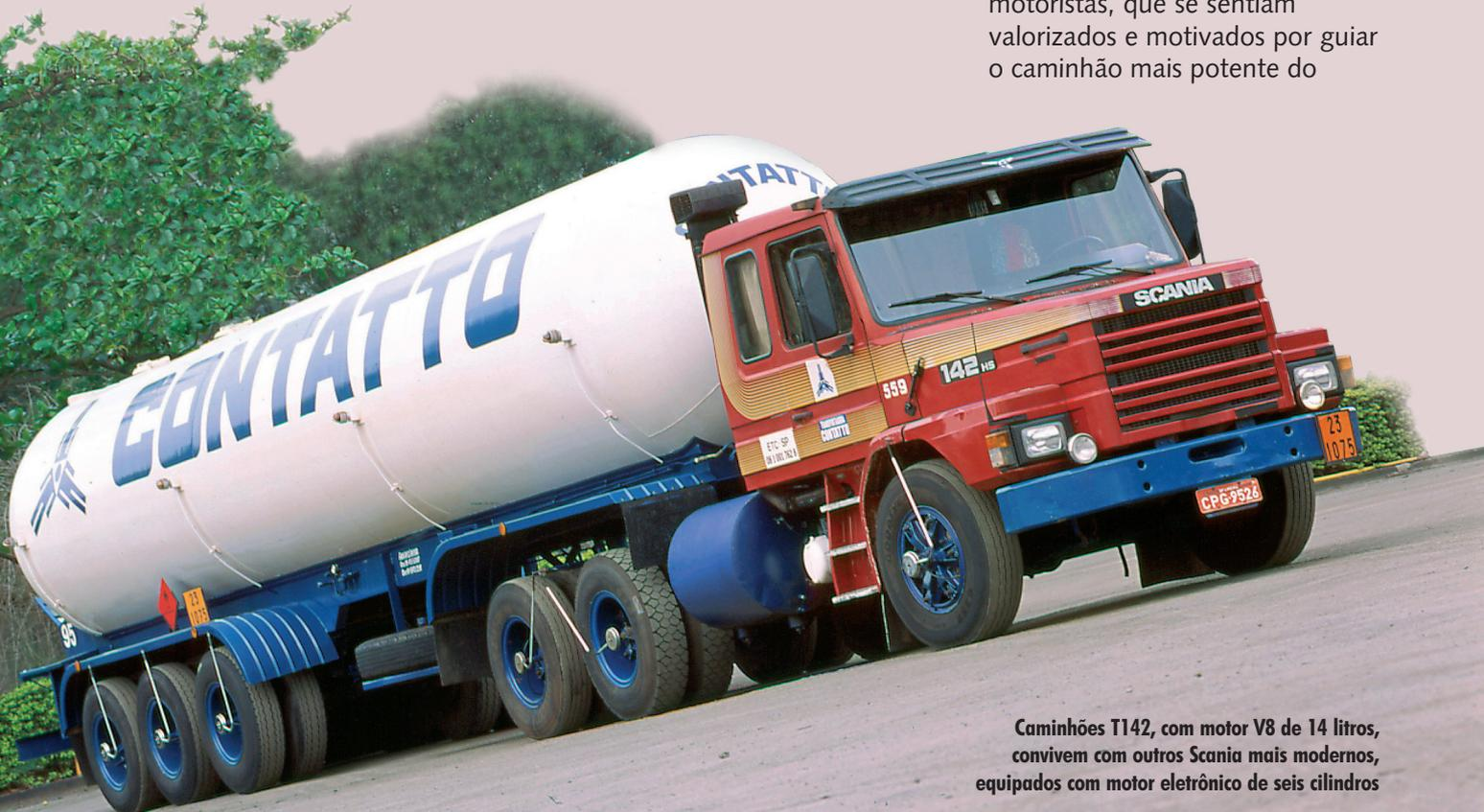
Caminhões T142, com motor V8 de 14 litros, convivem com outros Scania mais modernos, equipados com motor eletrônico de seis cilindros
