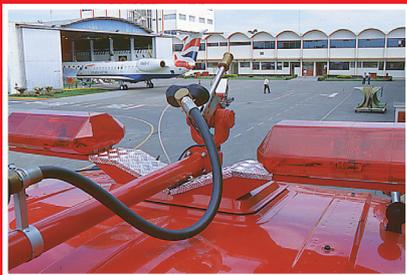
Caminhão Scania vai atuar na segurança de pousos e decolagens da nova pista da Embraer. O veículo é capaz de despejar 9,5 mil litros de água em um minuto e meio
