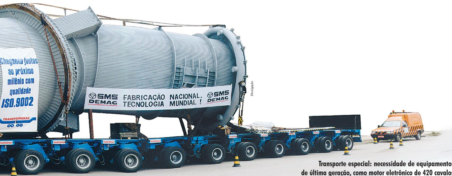
Transporte especial: necessidade de equipamentos de última geração, como motor eletrônico de 420 cavalos e linha de eixos francesa
