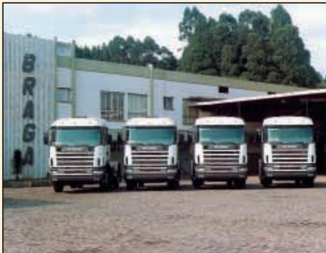
Quatro caminhões R124 GA 4x2 NZ equipados com motor de 360 hp, ABS, Scania Retarder e ar condicionado são as novas aquisições da Braga Transportes, tradicional empresa capixaba que atende há muitos anos as fábricas de chocolate do Estado.
